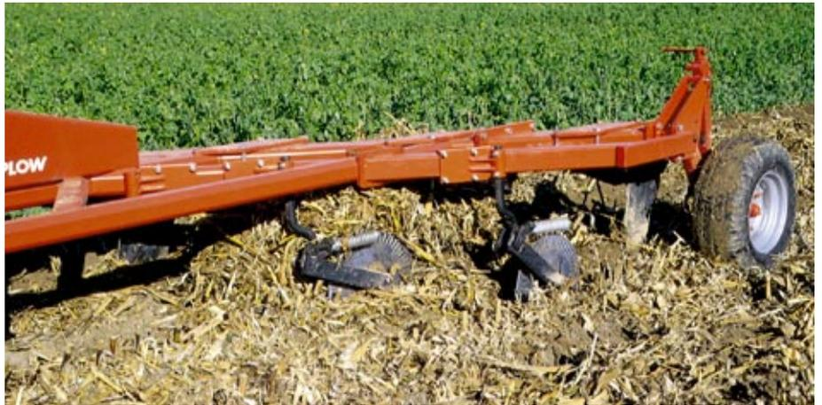
Der Parapflug HP 1512/5 ist mit Koppelpunkten der Kategorie II und III ausgerüstet – positiv. Durch den großen Abstand der Anbauplatten von 9 cm schieben sich die Unterlenkerkugeln auf den Bolzen beim Heben immer nach außen, bei der Zugarbeit werden die Unterlenker immer nach innen bewegt. Und beim Anbau landet man meistens mit dem Fanghaken der Unterlenker neben den Kugeln – negativ. Howard will dies ändern.
