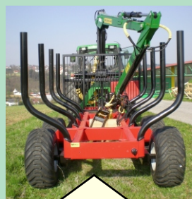
robuster Doppelrahmen hintere Lichtsteckdose 3 Rungen serienmäßig
