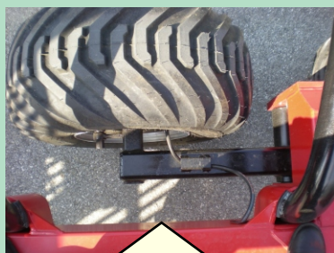
SF 9 mit hydraulischer Bremse gegen Auspreis auch mit Bremsdruckregelventil
