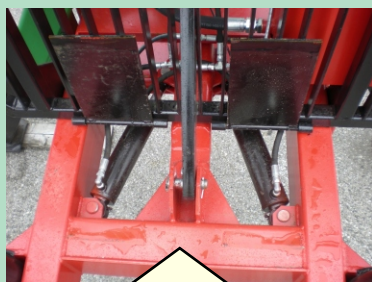
Starker Hebekran 2- Knic kzylinder 4- Kranzylinder
