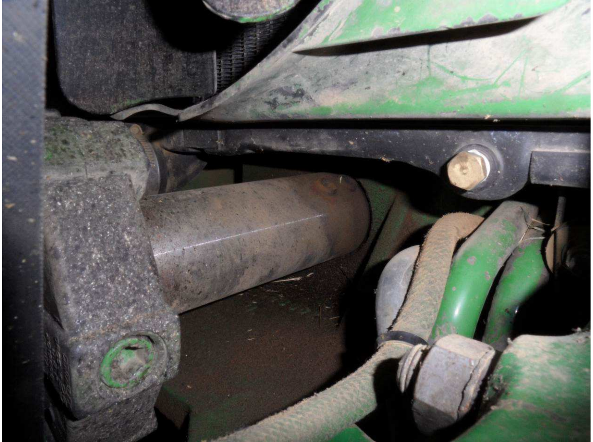
Antriebswelle zur Hydraulikpumpe
