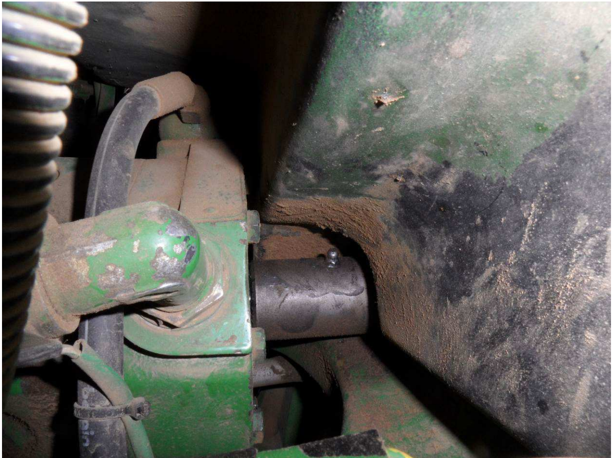
Verbindungsmuffe von Hydraulikpumpe zur Frontzapfwelle
