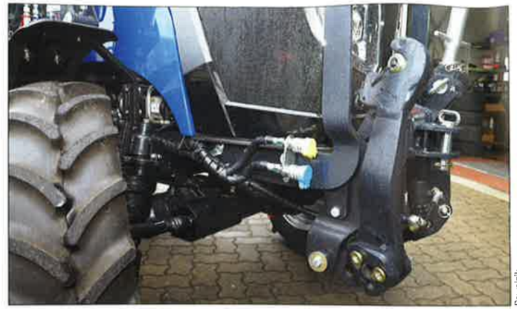
Foto oben: Die Fronthydraulik ist kompakt gestaltet. Kleines Foto: Schönes Detail: druckloser Rücklauf.
