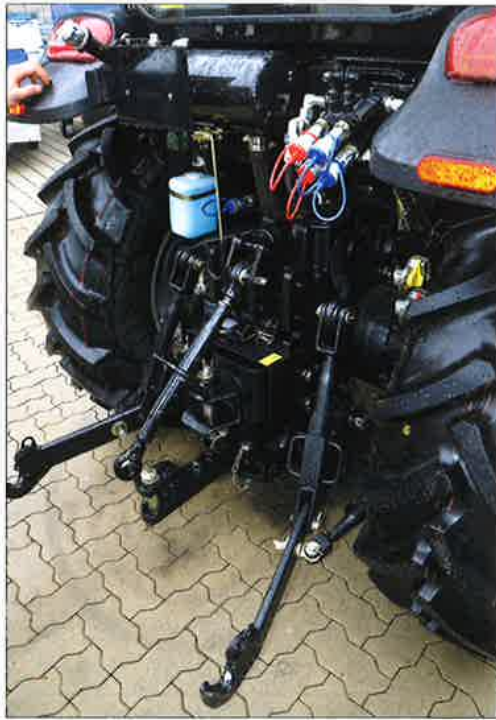
Foto links: Sehr gut erreichbare Hydraulikan schlüsse. Leider sitzt die Anhängerkupplung etwas tief und zum An-/Abbauen muss das Oberlenkerzwischenstück demontiert werden. In dieser Klasse fast ein Alleinstellungsmerkmal: die Zweikreis-Druckluftbremsanlage.
