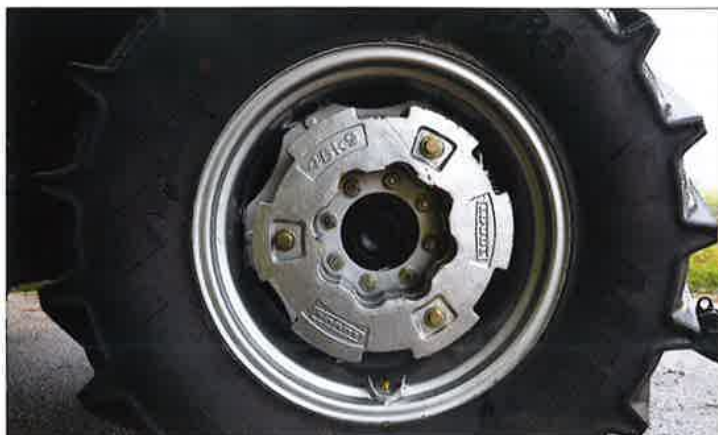
Radgewichte wie bei den „Großen“. Die Radmutter sind trotz der Gewichte frei zugänglich. Die Räder lassen sich auch mit den Radgewichten noch bewegen.
