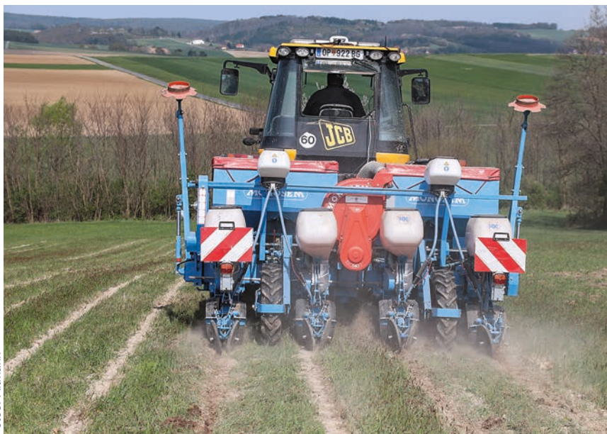
△ Etwa eine Woche nach dem Strip Till Gerät sät Grötschl den Mais in die Streifen.
