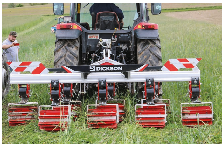
△ Mit dem so genannten Crimper von der Fa. Dickson aus OÖ knickt Franz Grötschl die Zwischenfrüchte nach der Aussaat nieder. Hier ein Bild von einer Vorführung im Mai 2019.
