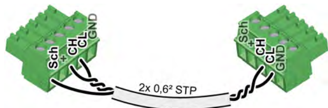
Abb. 5-1: CAN-Bus Verbindung zwischen Kessel
