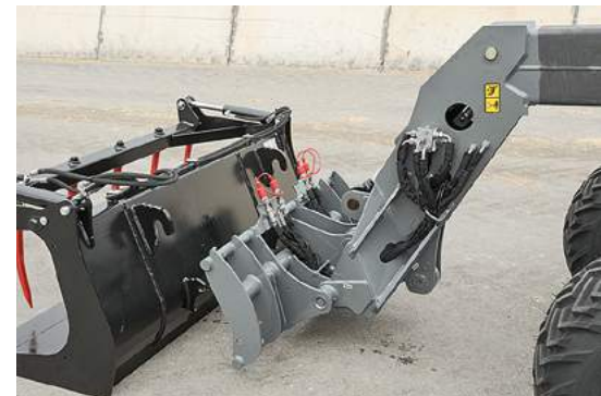
Zur Gerätekopplung bietet Giants verschiedene Rahmen mit hydraulischer Verriegelung an.
