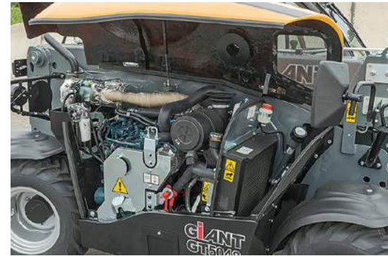
Der Dreizylinder von Kubota mit 50 PS kommt für die Abgasstufe V ohne AdBlue aus.
