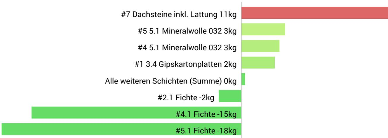
Dachkonstruktion,  $U=0,14 \text{ W}/(\text{m}^2\text{K})$
