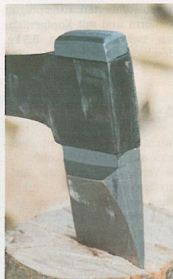
Eine von drei Testsiegern des Wochenblatt-Spaltaxtvergleiches ist die Fiskars Spaltaxt 2400. Der Axtkopf ist sozusagen in den Stiel eingegossen. Diese Verbindung hält auf jeden Fall.
