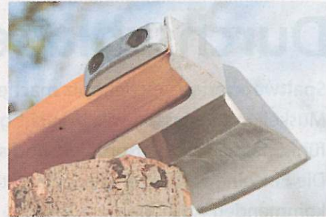
Statt durch das Verkeilen eine kraftschlüssige Verbindung zwischen Axtkopf und -stiel herzustellen, verschraubt Helko den Axtkopf an seinen Vario 2000 Modellen. Dadurch wird die Verbindung formschlüssig.
