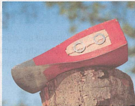
Dreifache Verkeilung mit einem Holz- und zwei Metall-Ringkeilen. Eine solide und sichere Lösung.
