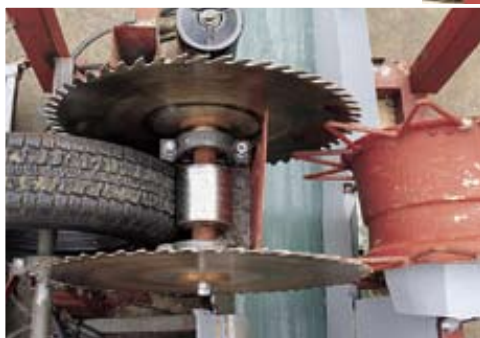
Oben die Hydraulik für den Vorschub. Die komplette Säge ist sehr einfach aufgebaut, der Schutz lässt sich zur Wartung komplett öffnen.
