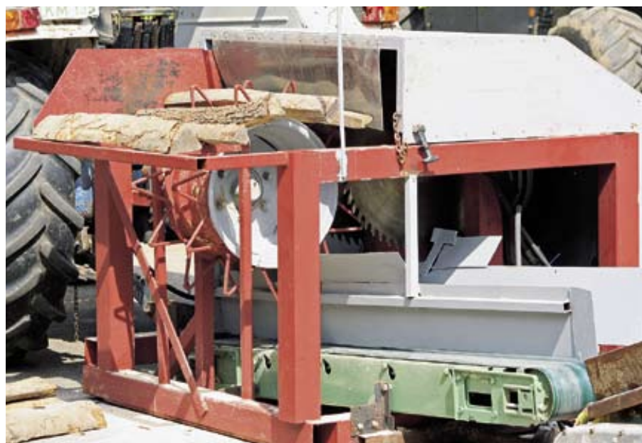
Die Sägeblätter sind komplett abgedeckt, die Trommel führt die Scheite sicher durch die Blätter. Die Serienmaschine wird zusätzlich einen Notstopp haben. Fotos: Höner
