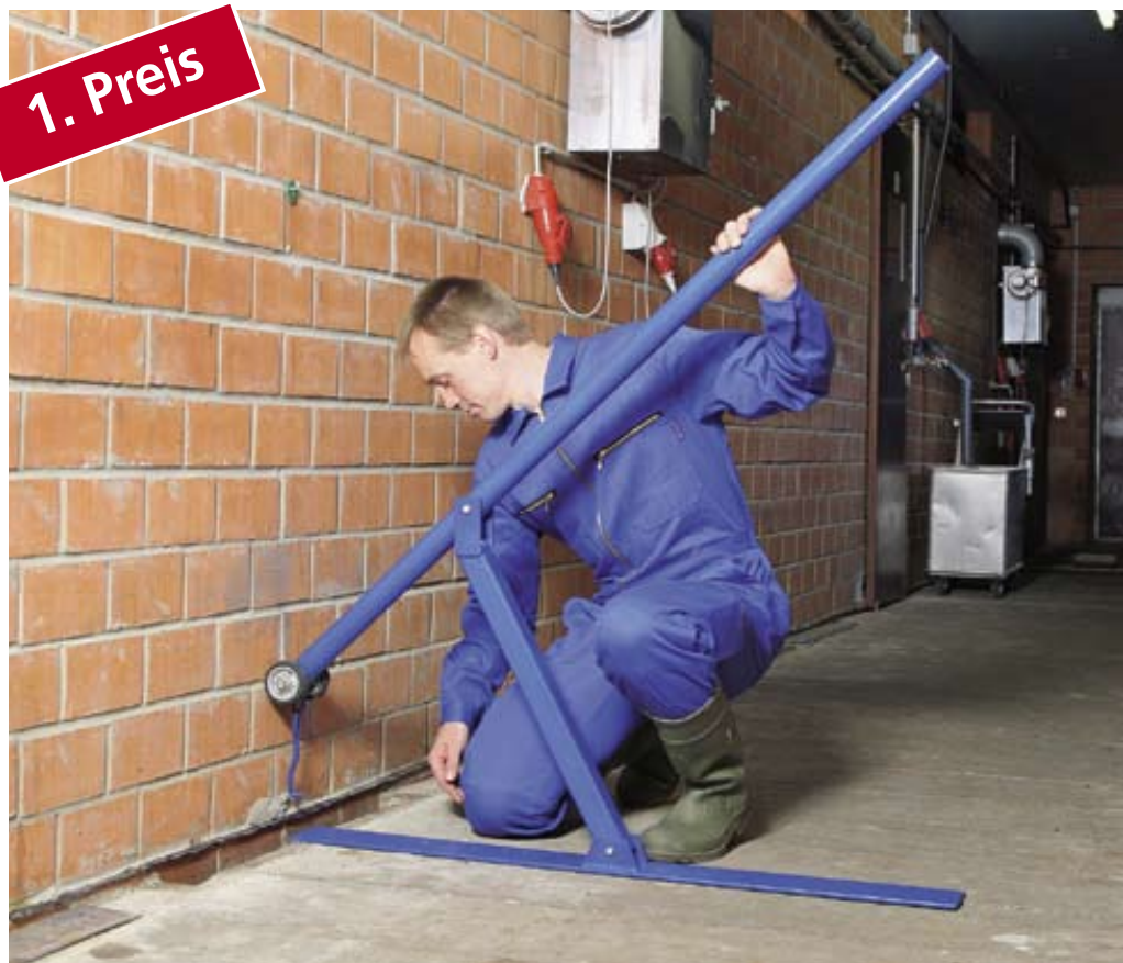
Zuerst bringt man den Hebel vor dem Schieber in Stellung. Die Haltenase greift in den Betonschlitz des Schiebers.
