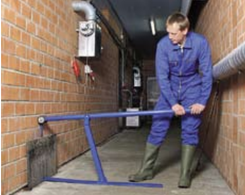
Beim Herunterdrücken laufen die Räder an der Wand hoch.
