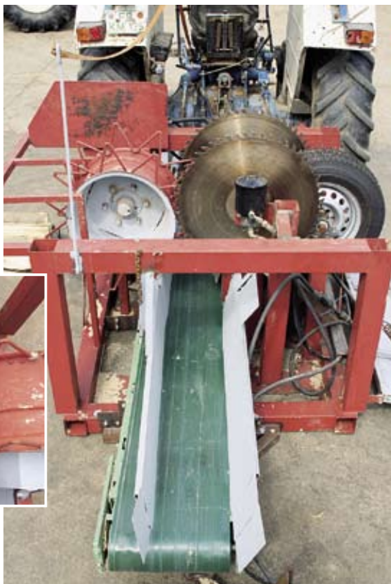
Oben die Hydraulik für den Vorschub. Die komplette Säge ist sehr einfach aufgebaut, der Schutz lässt sich zur Wartung komplett öffnen.
