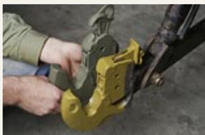
Ein sehr weit überstehender Verschluss könnte bei einer Kollision eher abbrechen.
