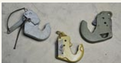
Die Fanghaken der verschiedenen Hersteller unterscheiden sich vor allem im Verschlussmechanismus.
